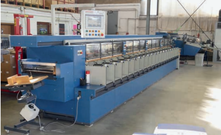
Eine werkstattüberholte Theisen & Bonitz-Zusammentragmaschine mit Heft-Falz-Schneid-Maschine wurde von Steuber bei Hossinger installiert.
