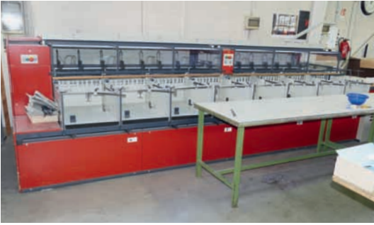
Eine tb sprint B208 VP steht bei Hossinger für Formate bis 50 x 70 cm zur Verfügung.
