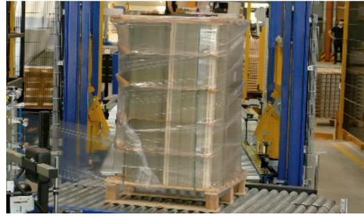
Paletten werden von der Mosca-Einpackstraße über ein internes Rollensystem und über verschiedene Sicherungsaggregate zum Umwickeln mit Folie platziert, um dann fertig verpackt dem Lager oder der Rampe zugeführt zu werden.
