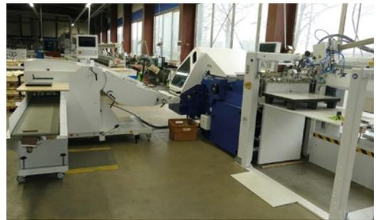
Teil 1 des Steuber-Pakets: die Kombifalzmaschine MBO K32 KSE (Komori Special Edition) für den 3B-Formatbereich in der Automatik-Version mit MBO-Auslage A80.
