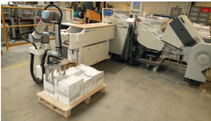
*Der mobile MBO CoBo-Stack von Steuber ist ein kollaborierender Roboter (Cobot) zum Absetzen von Stapeln und seit Januar 2021 bei D+L im Einsatz.*
