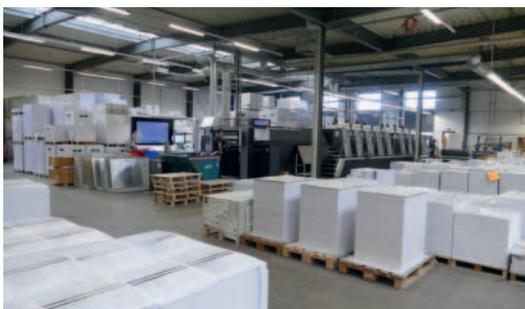
*Bogenoffset- und Werkdruck wird bei D+L mit jeweils zwei großformatigen 4/4- bzw. 1/1-Maschinen in jeweils einem Durchgang im Drei-Schicht-Betrieb gefertigt.*
