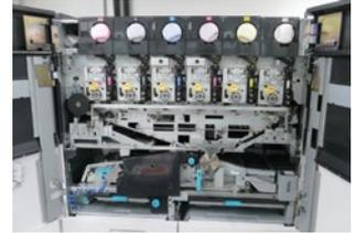
Bis zu sechs Farbstationen sind gleichzeitig online und ermöglichen den Einsatz von Spezialtonern sowie die Erzeugung von Texturen.
