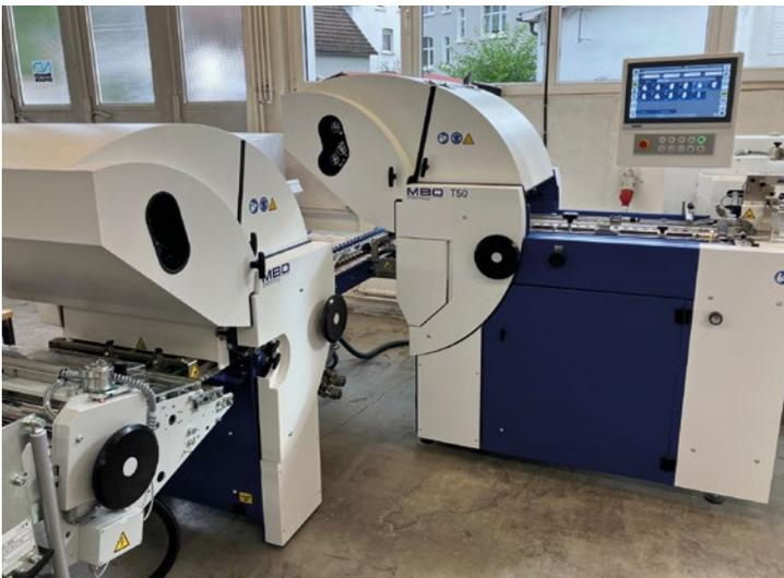
Die deutlich effizientere MBO T50 übernimmt bei Nuschdruck inzwischen die Falzaufgaben, die zuvor von zwei älteren MBO-Modellen erledigt wurden.
